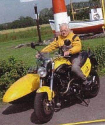
häufigsten einen Aufbau, bei dem der Beiwagen an zwei Gelenken frei neben dem Motorrad läuft. Alle Fahreigenschaften des Solobetriebes bleiben erhalten und in der Fahrdynamik sind Schräglagen wie bei Solofahrten, bis auf wenige Einschränkungen, möglich. Damit steht fest, dass Schwenkerfahren mit Gespannfahren im herkömmlichen Sinne nichts zu tun hat.
