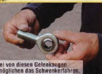
Zwei von diesen Gelenkaugen ermöglichen das Schwenkerfahren.
